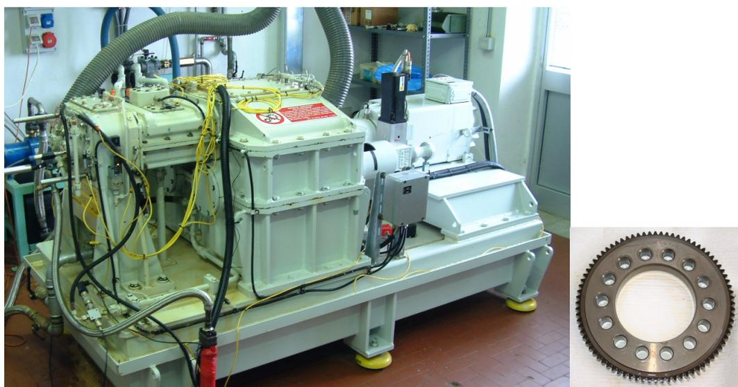
**Figura 8** - Banco prova ingranaggi a ricircolo di potenza e dentature campione utilizzate
