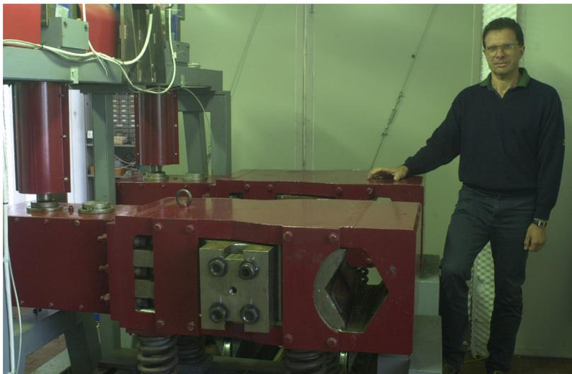
**Figura 1** – *Macchina a risonanza per prove di flessione alternata*
