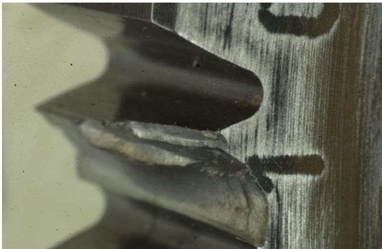
**Figura 9** – Esempio di rottura anomala di un dente.
