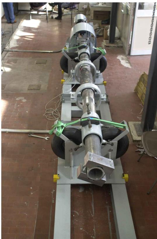
**Figura 2** – *Macchina a risonanza per prove di flessione rotante*
