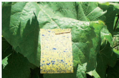
Figure 1.11: Aspect d'un papier hydrosensible après passage d'un pulvérisateur avec de l'eau (photo : B. Alban)
