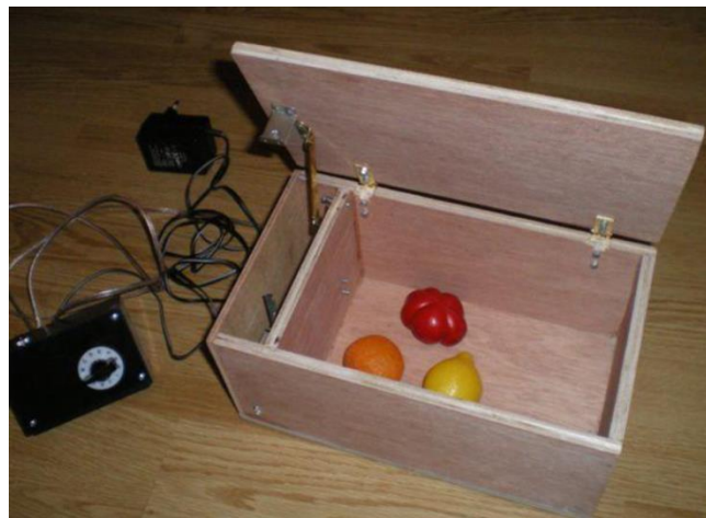
Figure 7.1 Boîte et son dispositif électronique d'ouverture minutée
