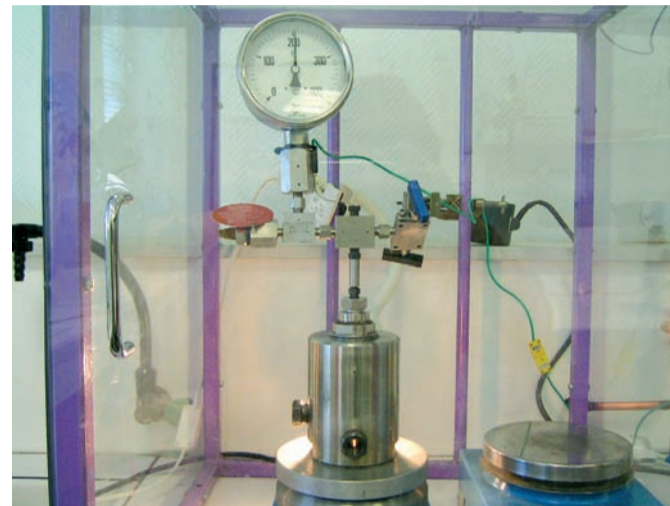
Autoclave à fenêtres en saphir pour l'étude des réactions en milieu supercritique
