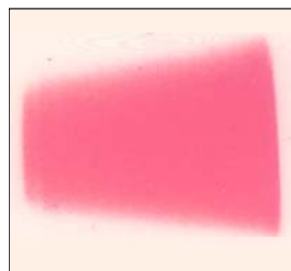
Fig. 5 – Area di contatto generata da un cattivo allineamento tra anello e disco (Pellicola Fuji Prescale HS)
