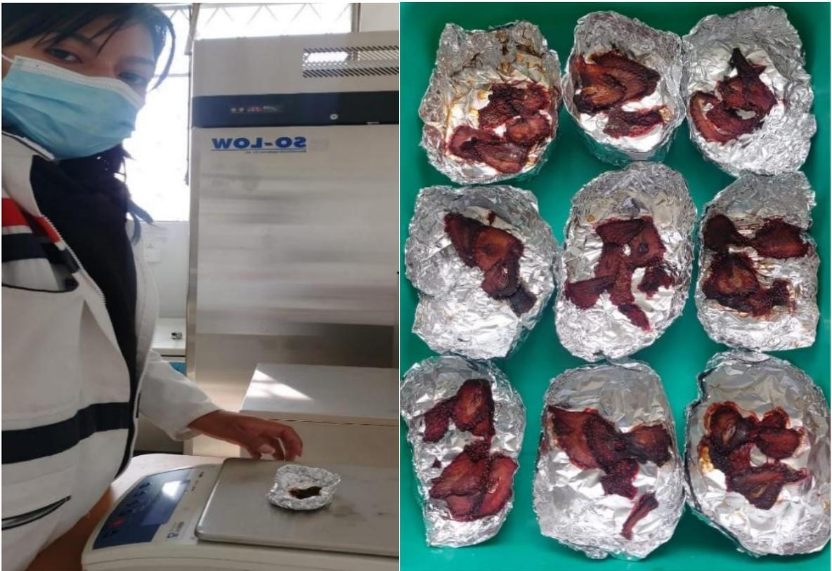
**Anexo 23.** Preparación de muestras para determinación de cenizas.
