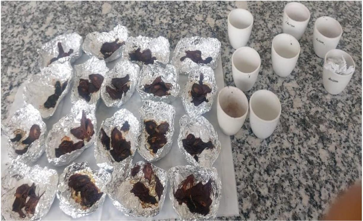
**Anexo 24.** Peso de crisol más muestra seca para determinación de cenizas.
