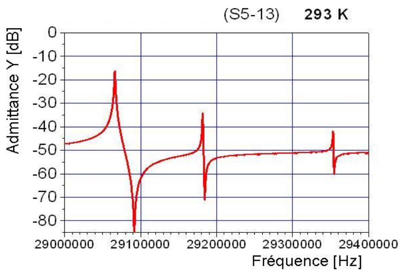
Figure 4.25. Spectre du résonateur QT no. S5-13 enregistré à 293 K.
