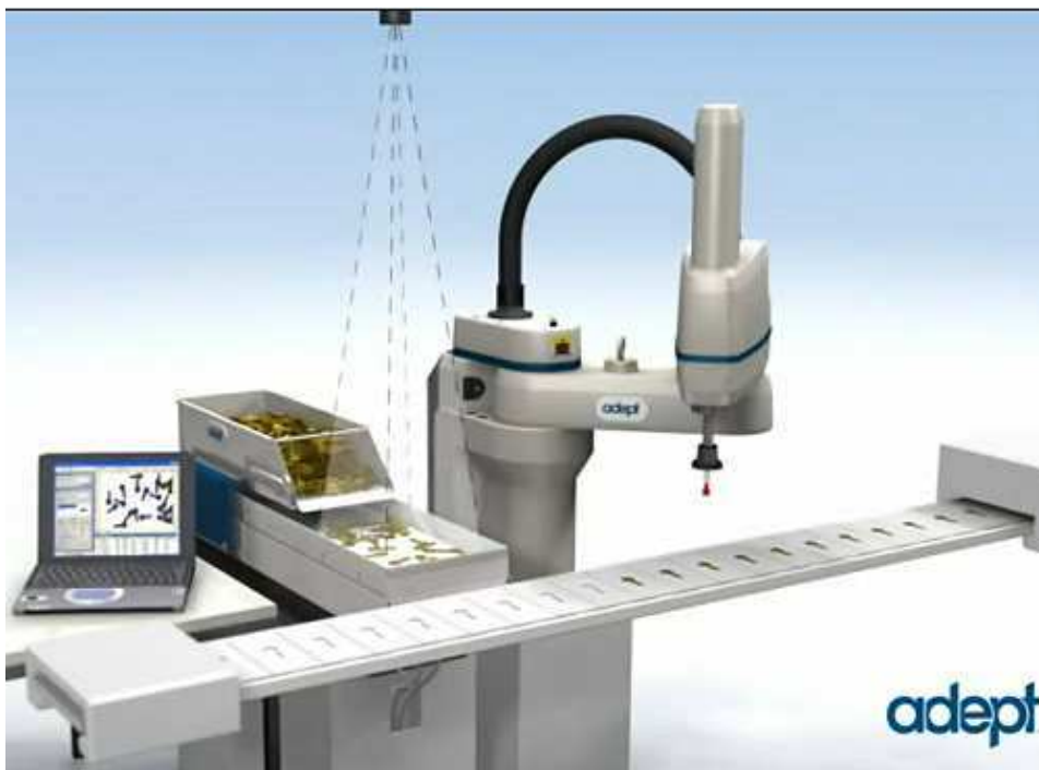
FIGURE 3.7 – Un robot Adept Cobra Scara réalisant une phase de prise et de dépose d'objets grâce à un système de vision et un système d'alimentation (Adept Anyfeeder).
