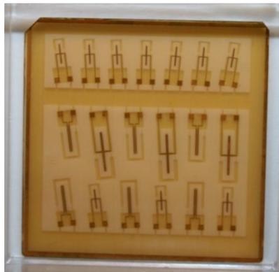
**Figure 101 : Echantillon de LGS après les étapes de photolithographie avec les masques des dispositifs V3.**
