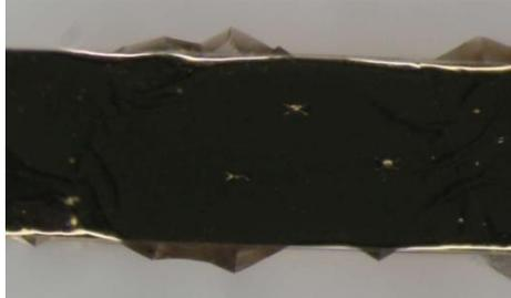
**Figure 106 : Bords irréguliers d'une poutre.**
