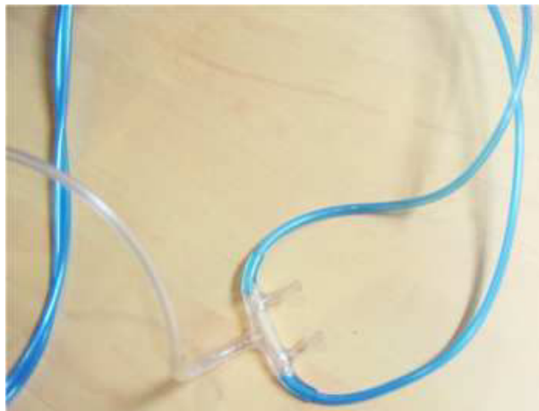
FIGURE 3.20 – Canules nasales et orales dont la partie orale est utilisée comme entrée pour le flux d'air odorant.
