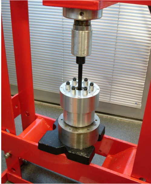
Figure 3.16 : Assemblage par emboutissage à l'aide d'une presse du paquet de tôle composant le stator
