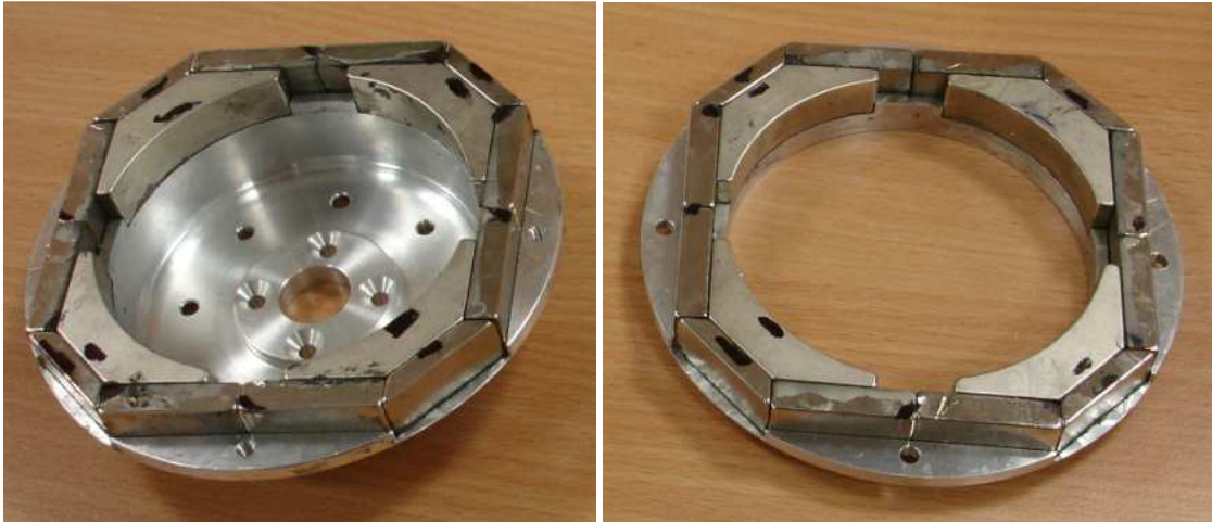
Figure 3.13 : Supports entrant dans la composition du rotor du démonstrateur
