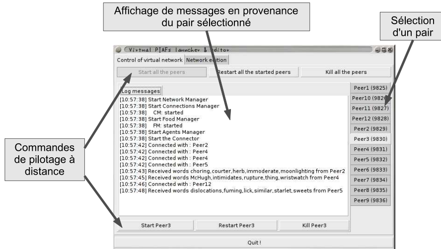
FIG. 6.2 – Interface graphique permettant de piloter à distance un ou plusieurs PIAFs
