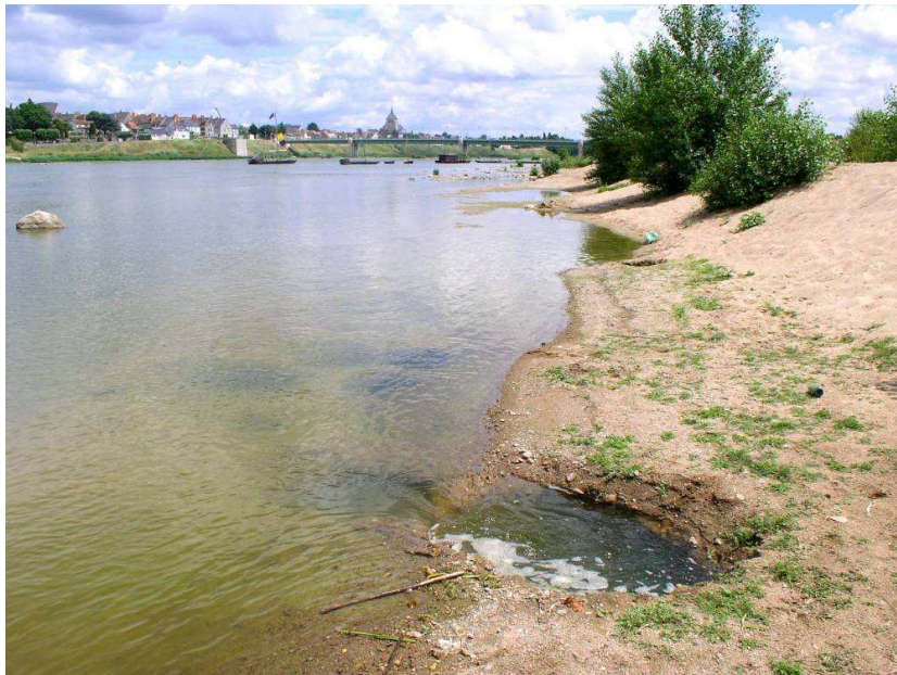
Fig 2.4 Vue des pertes de la Loire à Jargeau. Elles sont de l'ordre de 15 à 20 \text{ m}^3/\text{sec} et pourraient atteindre 100 \text{ m}^3/\text{sec} en crue.
