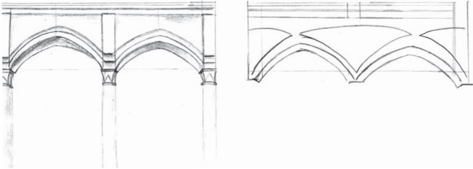
FIGURA 5.2. COLUMNAS FORMANDO UNA ARQUERÍA (A) Y LA ENJUTA TRIANGULAR QUE SE FORMA POR SU CONTIGÜIDAD (B)
