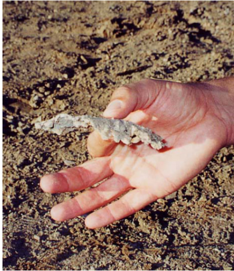
Figura 1. Particolare dell'effetto legante del collante Terra Control.
