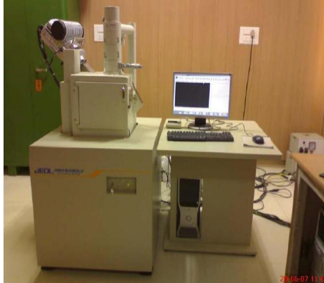
Fig.3.1: JEOL JSM-6480LV SEM.
