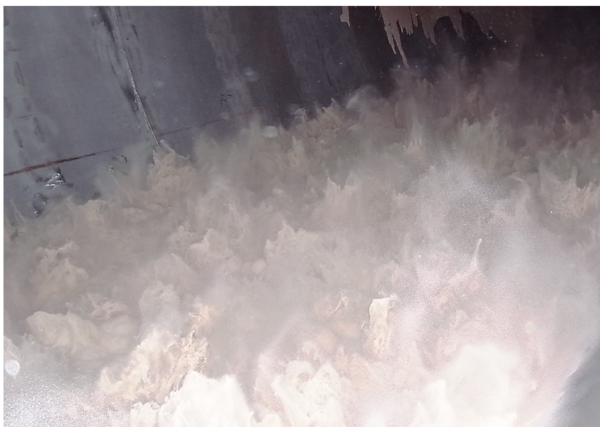
Rys. 4-19. Fluidalne złożo piasku szklarskiego w suszarce o wydajności 50 t/h zbudowanej wg projektu procesowego autora w 2011 r. w Roncevaux, Francja
