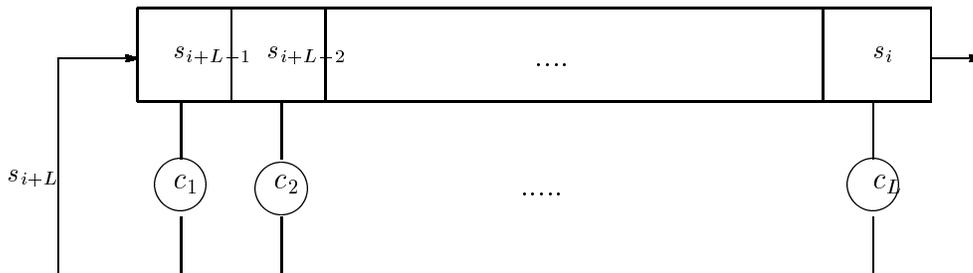
FIG. 12.1 – Registre à décalage à rétroaction linéaire de longueur  $L$
