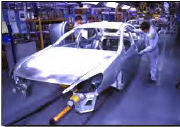
Figure 1-7 : La caisse sur une chaîne de montage
