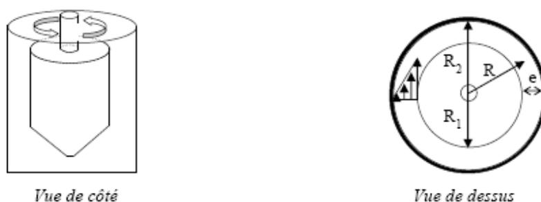
Figure II.10. Principe du système de type "Couette".
