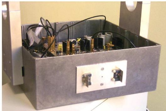
FIG. IV.34 – Système radar FM-CW
