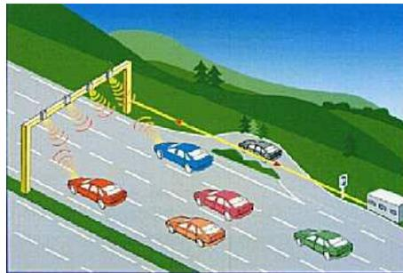
FIG. II.1 – Système multivoies de télépéage
