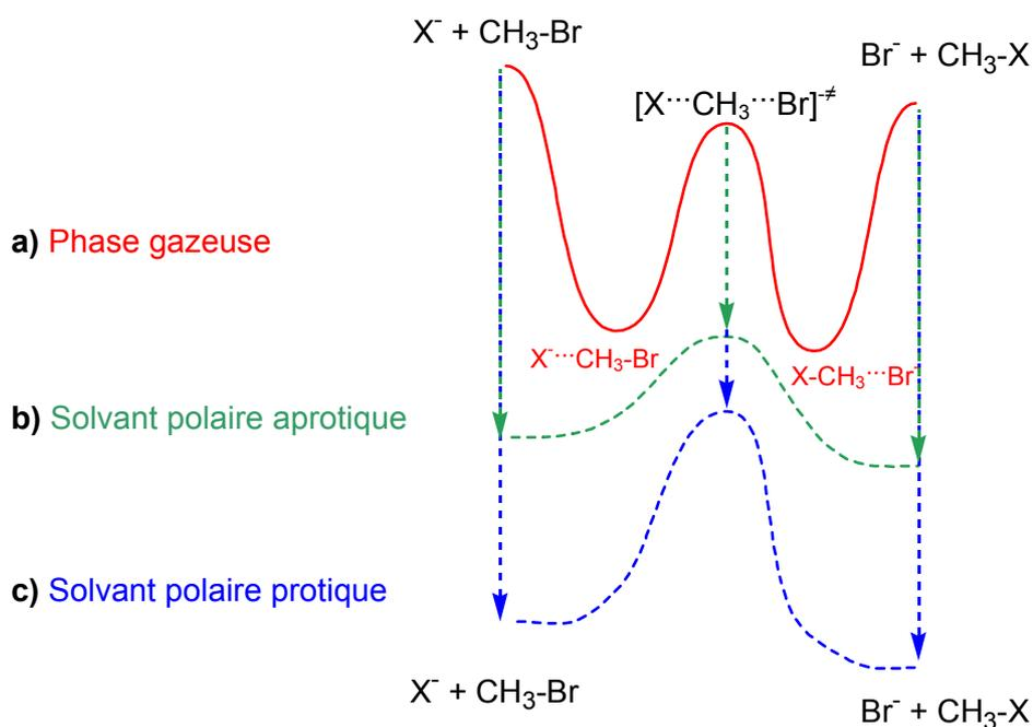
**Figure I-8 :** Profil énergétique de la réaction de  $S_N2$  :  $X^- + CH_3Br \rightarrow CH_3X + Br^-$  **a)** en phase gazeuse, **b)** en phase liquide avec un solvant polaire aprotique **c)** en phase liquide avec un solvant polaire protique.
