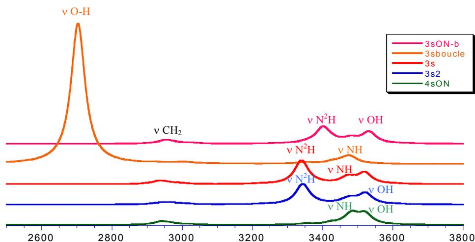
**Figure V-11 :** Spectres IR simulés dans la gamme 2500-3800 cm<sup>-1</sup> pour les cinq conformères de plus basse énergie de Gly<sub>3</sub>-Na<sup>+</sup> au niveau B3LYP/6-31G\*.
