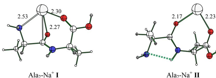
**Figure V-2** : Structures des diastéréoisomères les plus bas en énergie de Ala<sub>2</sub>-Na<sup>+</sup>.
