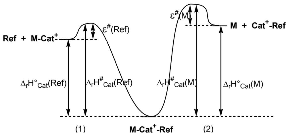
Figure II-2 : Profil réactionnel de la dissociation du dimère M-Cat<sup>+</sup>-Ref selon les voies (1) et (2).
