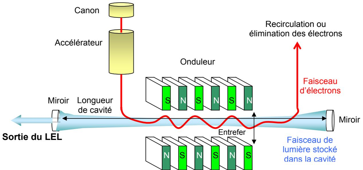
Figure III-1 : Schéma de principe du LEL CLIO.
