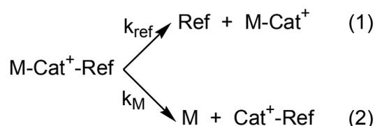
La voie (1) correspond à la dissociation de la liaison  $\text{Cat}^+\text{-Ref}$  avec la constante de vitesse  $k_{\text{ref}}$ . Selon la voie (2) on dissocie la liaison  $M\text{-Cat}^+$  avec la constante de vitesse  $k_{\text{M}}$ . Le profil réactionnel thermodynamique est donné sur la figure II-2.
