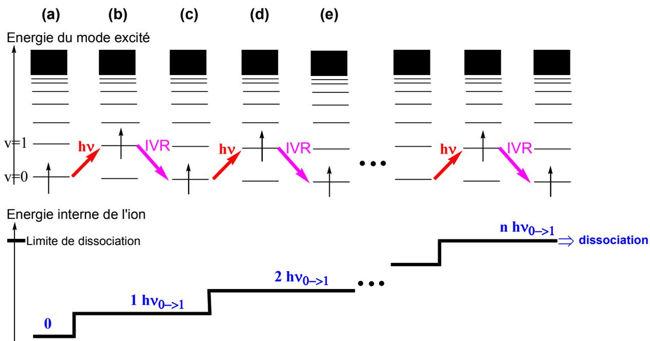
Figure II-4 : Principe de la spectroscopie IRMPD.
