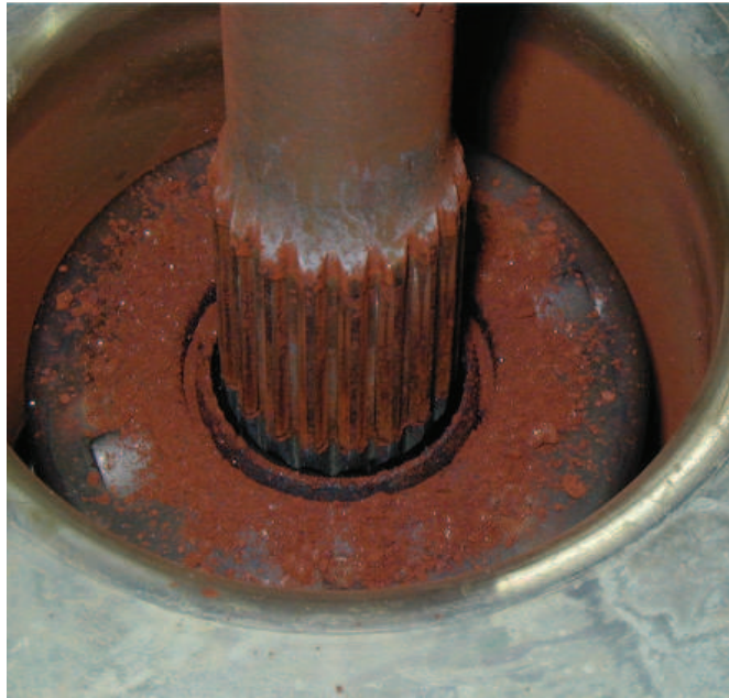
Figure 2.3. Aperçu des endommagements sur la liaison cannelée de la motorisation hybride.
