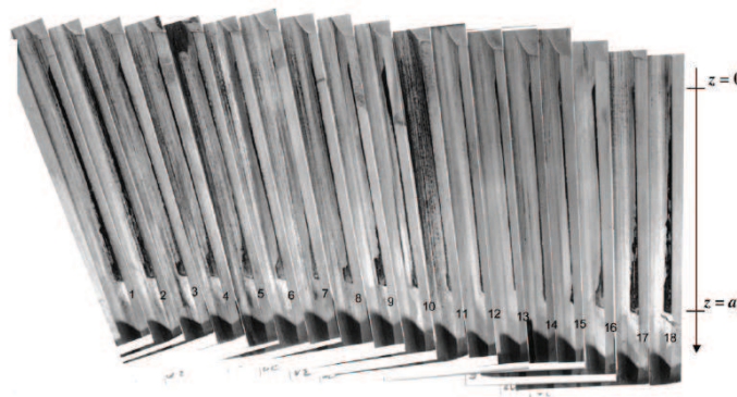
Figure 1.9. Observation microscopique des 18 flancs usés issus de l'arbre après essai. La répartition d'usure n'est pas uniforme (d'après [90]).
