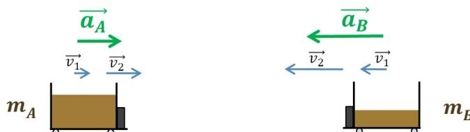
FIGURE 3.3.2 – Deux chariots de sable de masse variable
