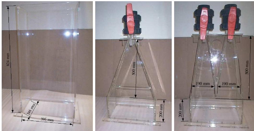
FIG. 6.1 – Dimensions de la cellule, de la trémie simple et de la trémie double de la maquette de silo utilisée.
