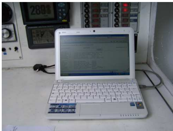
Le PC communique via un câble Internet avec le processorHR et peut prendre éventuellement la main pour commander le pilote.
