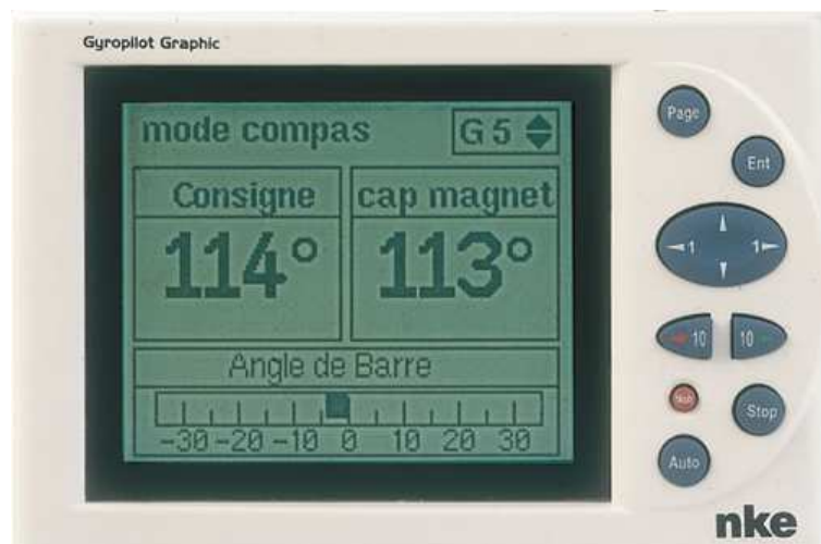
Le Gyropilote de nke en action en mode compas ! D'une part la consigne, d'autre part la mesure. L'erreur est donc ici de un degré. Le gain est accessible en façade (et s'affiche en haut à droite) et l'angle de barre donne une indication sur l'équilibre du bateau. Les touches Auto et Stop sont en bas à droite et les modifications de consignes ( \pm 1 , \pm 10 ) juste au-dessus.
