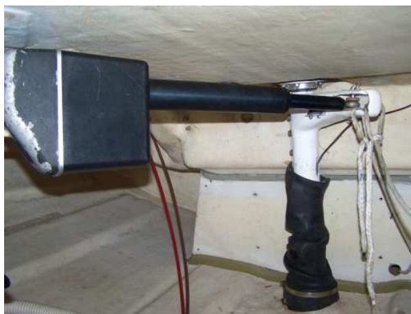
Vérin du pilote. La puissance développée par ce type de vérin exige un montage fiable et robuste pour éviter des bris de matériel. La mèche est prisonnière d'une machoire munie d'un petit bras de levier sur lequel est solidarisé le piston du vérin. Le bas de la mèche est étanchéifié avec une chambre à air d'automobile (la ligne de flottaison ne dépassant jamais le haut de cette chambre à air). On remarque le câble gainé en noir du pont de jauge dans le fond de l'image et les butées de barre (bouts blancs amarrés en tête du bras de levier) qui limitent la course du vérin.
