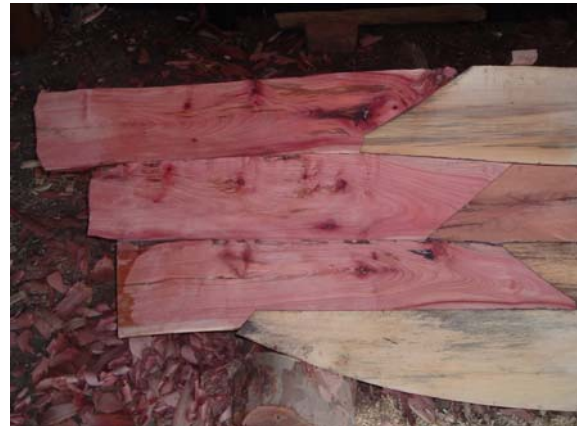
Photographie 76 : Assemblage entre quille et galbord
