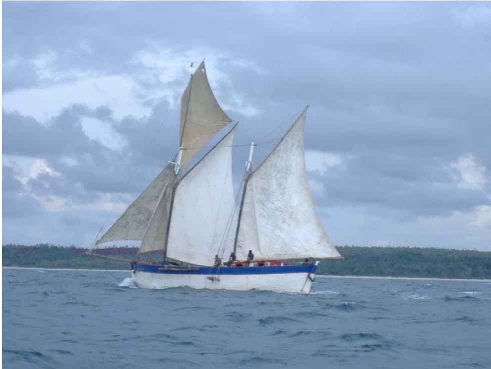
Photographie 99 : Goélette à gréement aurique filant travers au vent toutes voiles dehors avec foc et trinquette, grand voile, flèche et artimon
