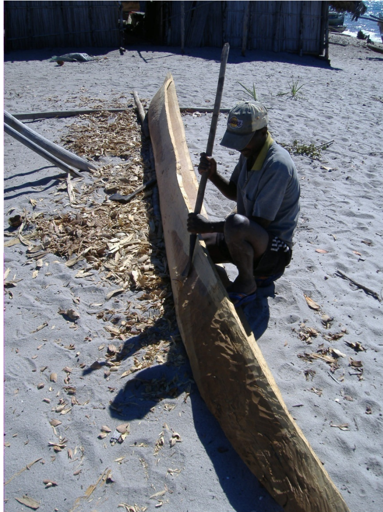
Photographie 70 : A Anjamanjoro, charpentier travaillant au fitoraka l'extérieur d'une quille en mojiro d'une future pirogue de transport
