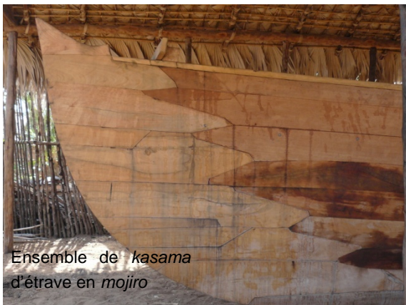
Photographie 80 : Vue de profil de la partie avant côté bâbord d'une coque de pirogue de transport de onze mètres, construite sous abri à Soalala
