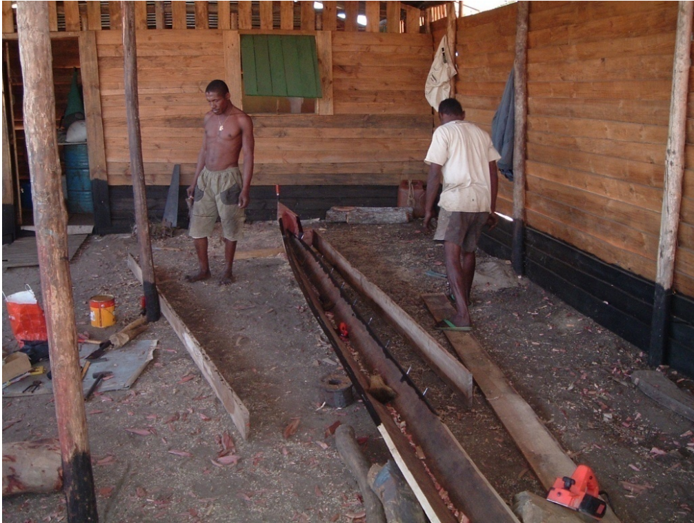
Photographie 71 : A Ambalamanga, montage des galbords et des premières kasama sur une quille de onze mètres.
