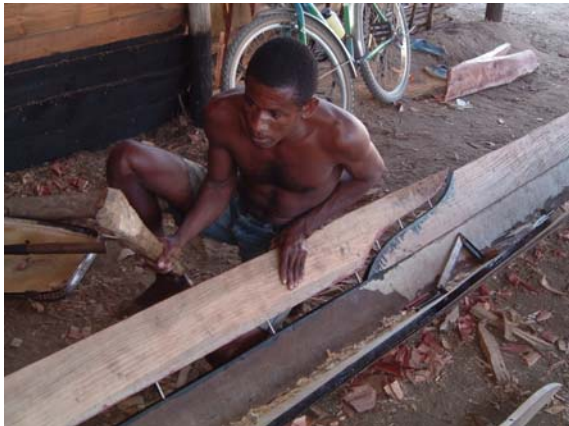
Photographie 76 : Assemblage entre quille et galbord
