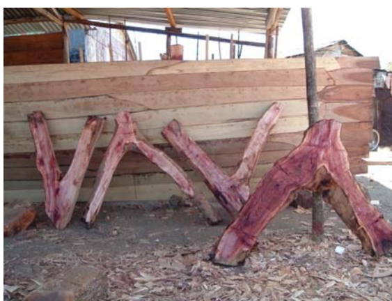
Photographie 84 : Dégrossissage à la hache d'une membrure en moromony
