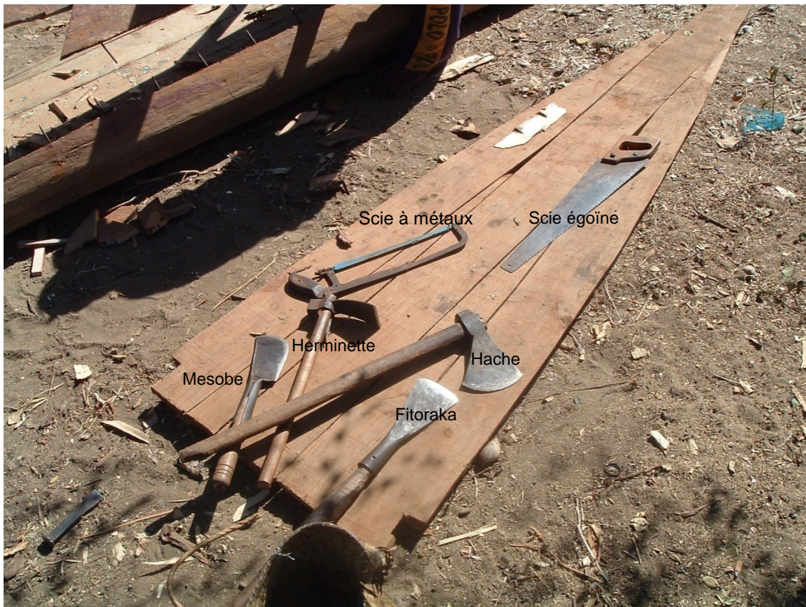
Photographie 69 : L'outillage de base des charpentiers de navire pour la construction d'une pirogue à balancier (manquent la chignole à main et le marteau)
