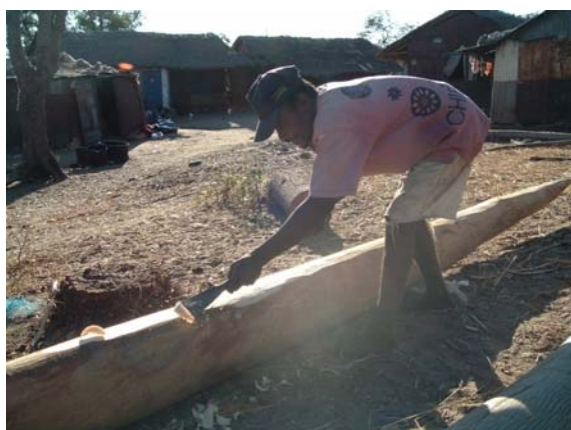
Photographie 95 : A Ambalamanga, taille d'un flotteur en pamba à l'aide du fitoraka
