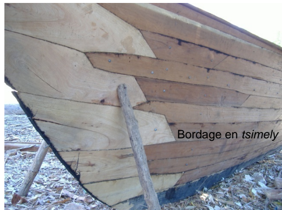
Photographie 80 : Vue de profil de la partie avant côté bâbord d'une coque de pirogue de transport de onze mètres, construite sous abri à Soalala
