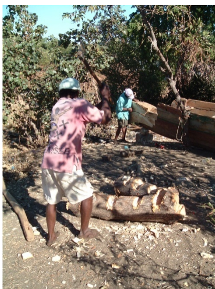
Photographie 84 : Dégrossissage à la hache d'une membrure en moromony
