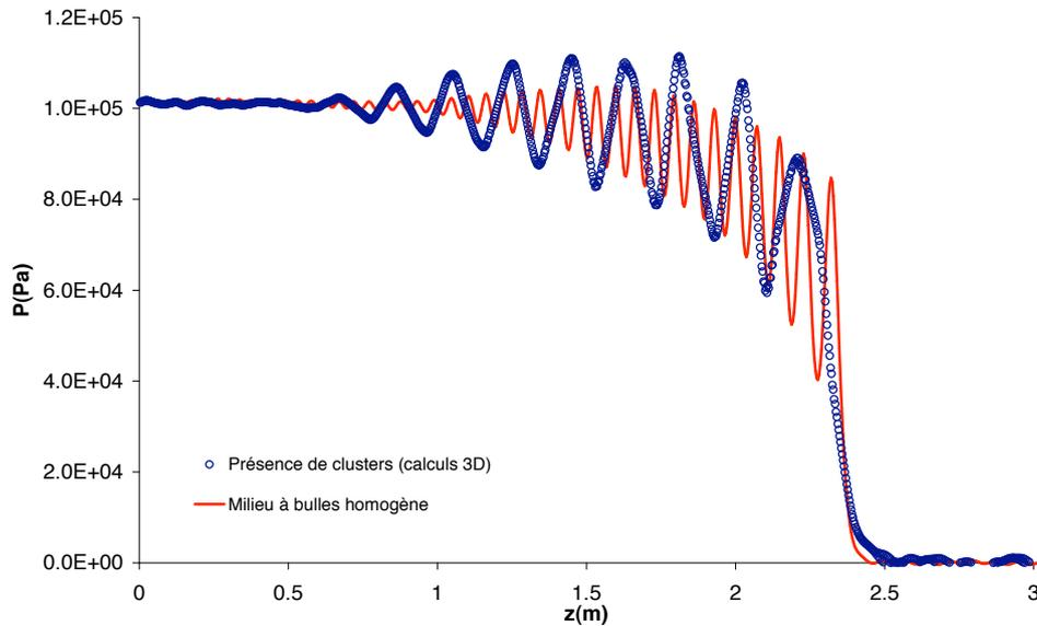
FIG. 4 – Effet de la présence de clusters sur la structure d’une onde de choc dans un milieu à bulles - Rayon initial des bulles  $a^0 = 2\text{mm}$  - Rayon initial des clusters  $R_1^0 = 3.48\text{cm}$  - Porosité initiale dans les clusters  $f_0 = 5\%$  - Porosité initiale moyenne  $f_{m_0} = 1\%$  - Fraction volumique initiale occupée par les clusters  $\alpha_0 = 20\%$
