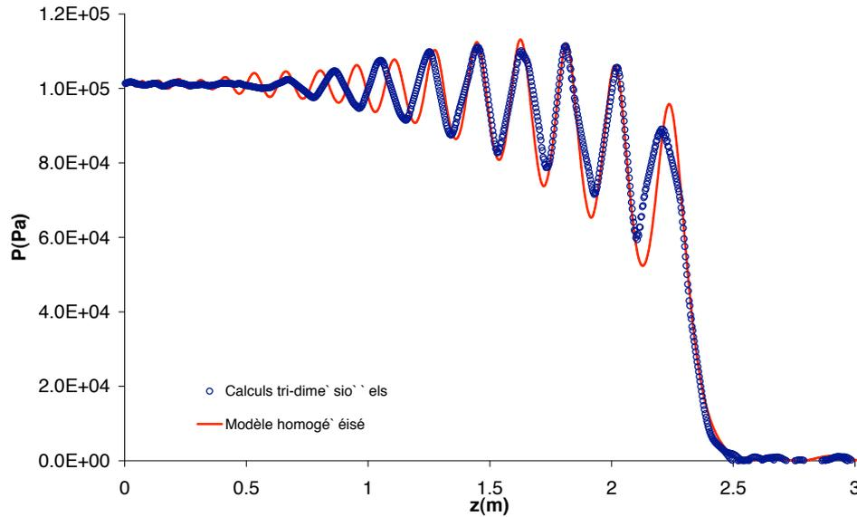
FIG. 6 – Comparaison entre simulations tri-dimensionnelles et modèle homogénéisé - Rayon initial des bulles  $a_0 = 2\text{mm}$  - Rayon initial des clusters  $R_1^0 = 3.48\text{cm}$  - Porosité initiale au sein des clusters  $f_0 = 5\%$  - Porosité initiale moyenne  $f_{m_0} = 1\%$  - Fraction volumique initiale occupée par les clusters  $\alpha_0 = 20\%$
