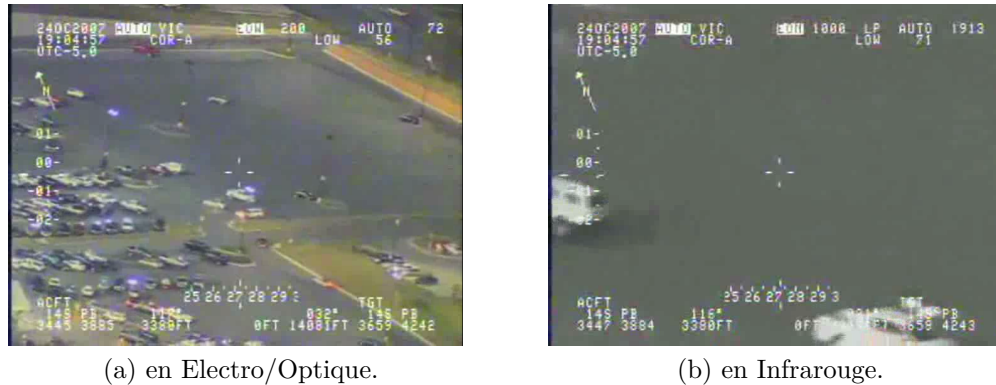
FIGURE 7.19 : illustration de la différence d'image pour une même visée avant et après le changement d'optique.
