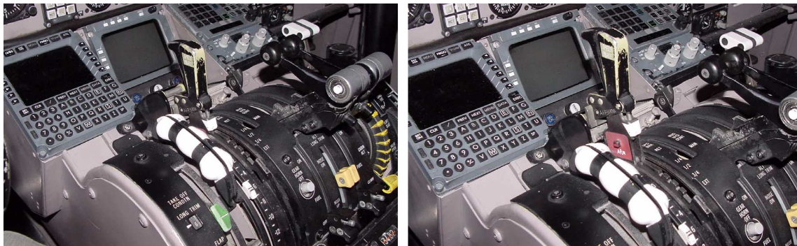
FIGURE 5.15 : différence sur le McDonnell Douglas MD-82 entre un mode où les aérofreins ne sont pas armés (à gauche) et armés (à droite) (extrait de NTSB, 1999).
