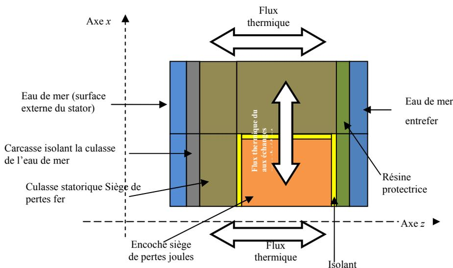
**Figure 4 : Représentation des matériaux sujets à des flux thermiques sur un pas dentaire (encoche + dent)**
