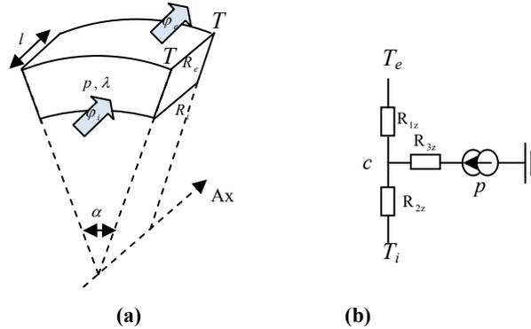
Figure 5 : Représentation (à gauche (a)) et modélisation (schéma en T à droite (b)) d'un transfert thermique avec source interne et échange thermique axial
