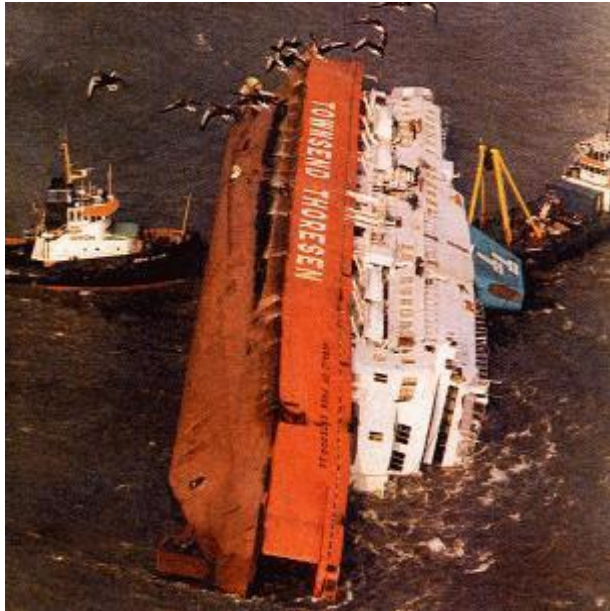
Figure 5 : Le Herald of Free Enterprise chaviré, porte avant ouverte
