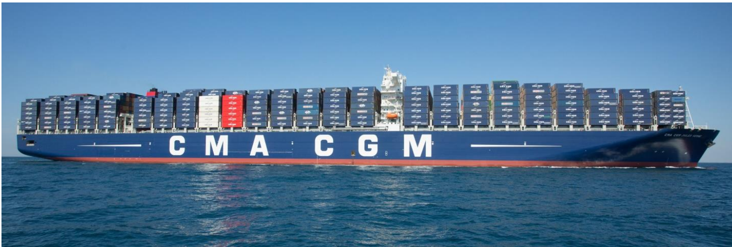
Le « CMA-CGM JULES VERNES », porte-conteneurs de la compagnie CMA-CGM (2013), Longueur hors-tout : 396 mètres, capacité : 16020 containers de 20 pieds.
