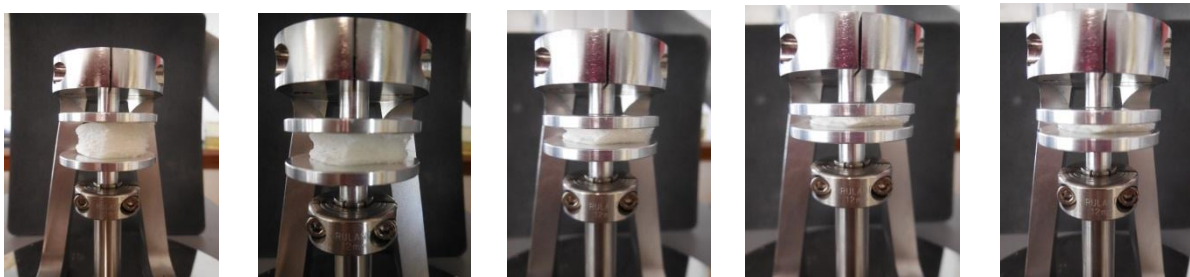
Figure II.15 : Exemple de test de compression uniaxiale sur un aérogel.
