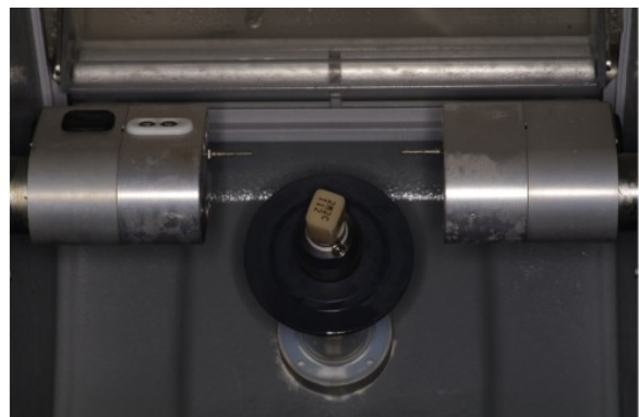
Fig. 3.37 : Station d'accueil du bloc Vita Mark II au sein de l'usineuse Cerec MC X (courtoisie Blanc R.).
