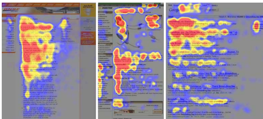
Figure 5.6 : image d'enregistrement d'un parcours avec un oculomètre. Photo originale Uselt://www.mon-design-web.com/que-voient-visiteurs.php
