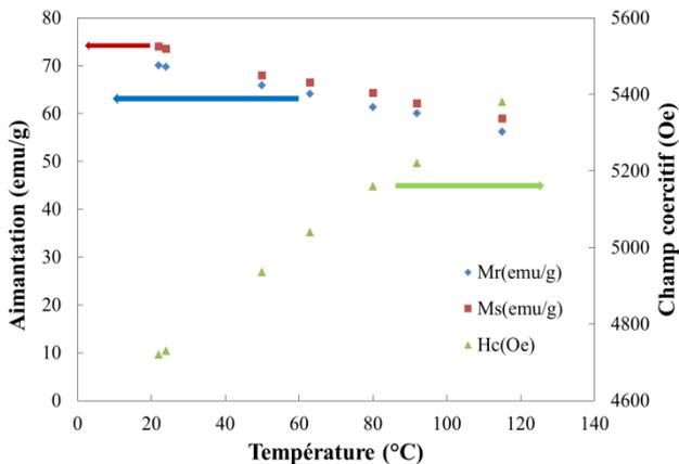
Figure 5. Evolution de l'aimantation (rémanente et à saturation) et du champ coercitif intrinsèques du ferrite (La,Co)-SrM en fonction de la température.
