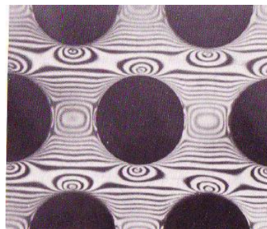
Figure I. 30 - Répartition des contraintes de déformation mesurées par photoélasticimétrie au sein d'un modèle d'inclusion sollicité en traction transverse [78]
