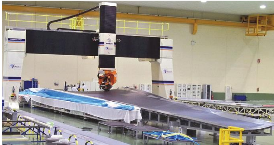
Figure I. 3 - Exemple de pièces aéronautiques drapées par le procédé de placement de bande automatisé : Revêtement de voilure de l'A350 XWB (MTorres® [23])
