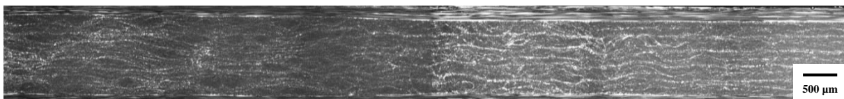
Figure III. 6 - Microstructures des stratifiés dans la zone de singularité, empilement [0^\circ/90^\circ_s/0^\circ] :
