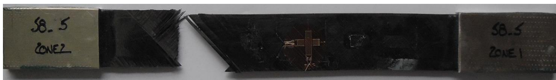
Figure III. 40 - Faciès de rupture d'une éprouvette de référence drapée par AFP d'empilement [(-45^\circ/+45^\circ)_3/-45^\circ]
