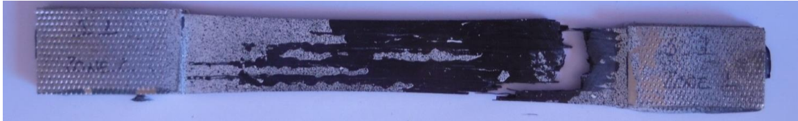
Figure VII. 9 - Faciès de rupture d'une éprouvette contenant un rayon de courbure de 1000 mm
