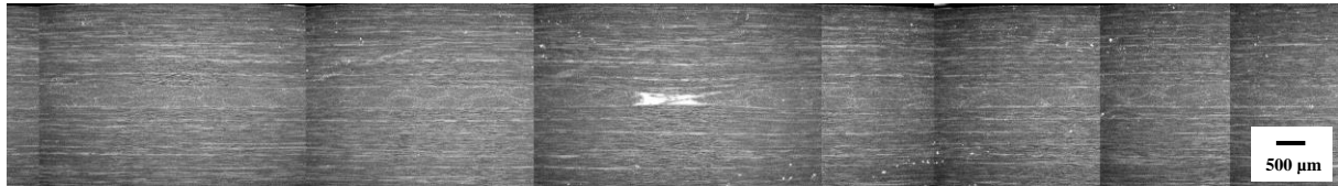
Figure IV. 9 - Rappel de la microstructure d'un stratifié contenant un gap de 6,35 mm drapé par AFP, empilement [0^{\circ}_7/90^{\circ}_2/0^{\circ}_7] : (i) Polymérisation sans contre plaque ; (ii) Polymérisation avec contre plaque
