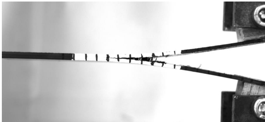
Figure IV. 16 - Photographie d'une éprouvette de référence drapée par AFP (gap 0,5 mm) testée en Mode I avec la présence de pont de fibre entre les deux plis centraux orientés à 90°, empilement [0^{\circ}_7/90^{\circ}_2/0^{\circ}_7]
