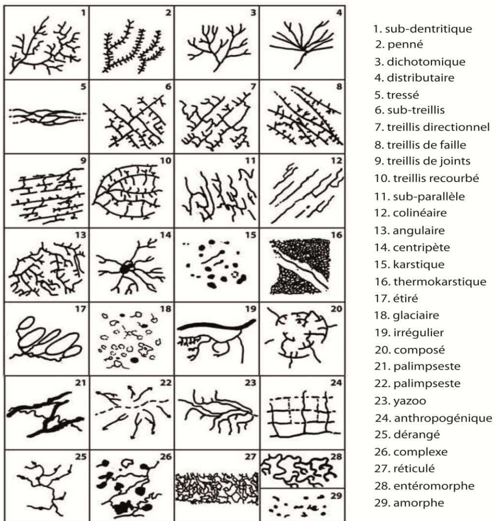
Fig. 4.22. Classification descriptive du réseau hydrographique proposée par Howard (1967) : A) types de base de réseaux hydrographiques ; B) types modifiés de réseaux hydrographiques.
