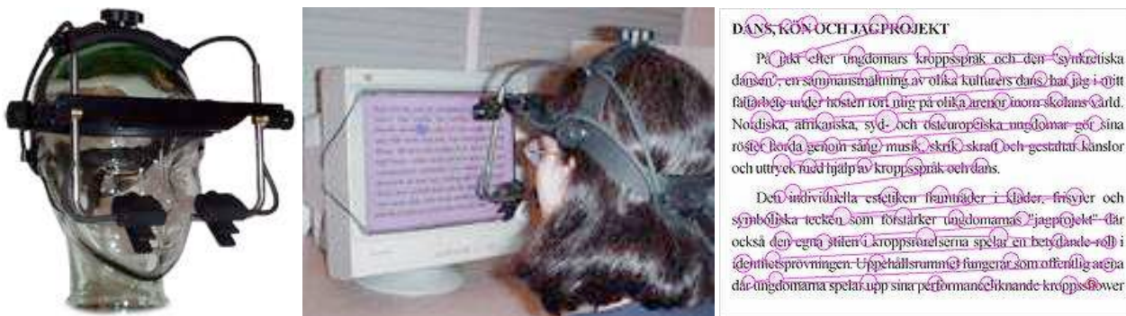
Figure 21 : Appareil d'eye tracking, exemple d'utilisation et résultat pour l'analyse de la lecture en saccades (appareil EyeLink II commercialisé par SR-research 25 ).
