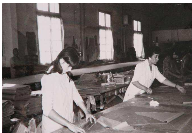
3- Les ouvrières traçant les limites du ponçage
