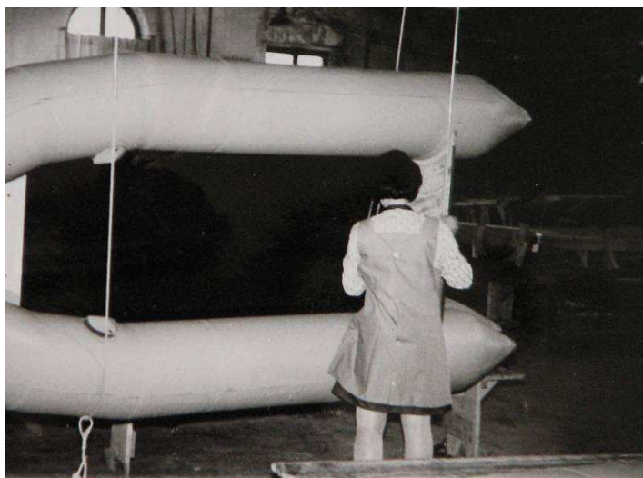
7- La pose du tableau
