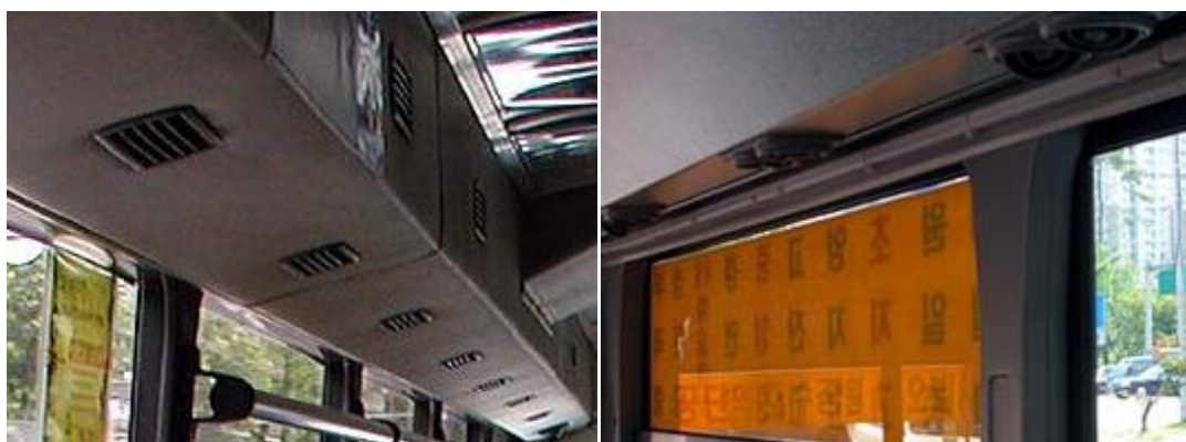
Fig. 12 Climatisation non-réglable (à gauche) et réglable (à droite) dans le bus
