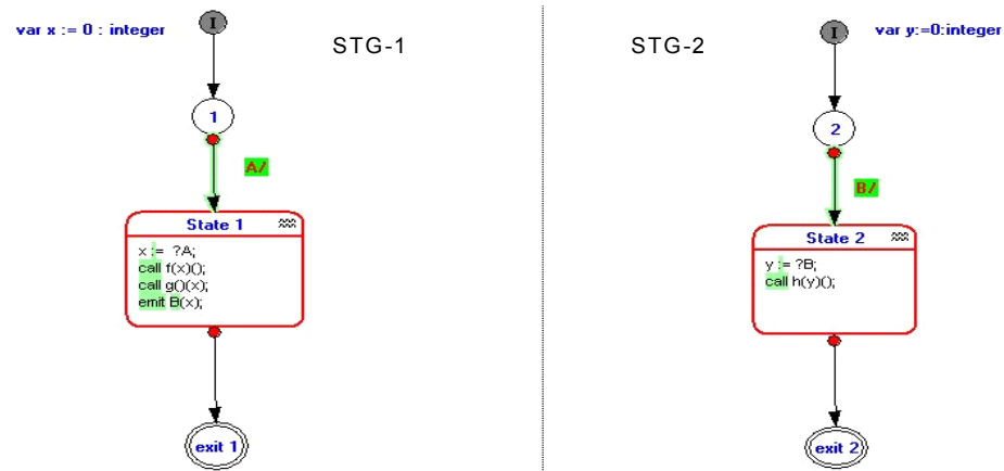
FIGURE 2.9. Exemple de communication entre deux STG
