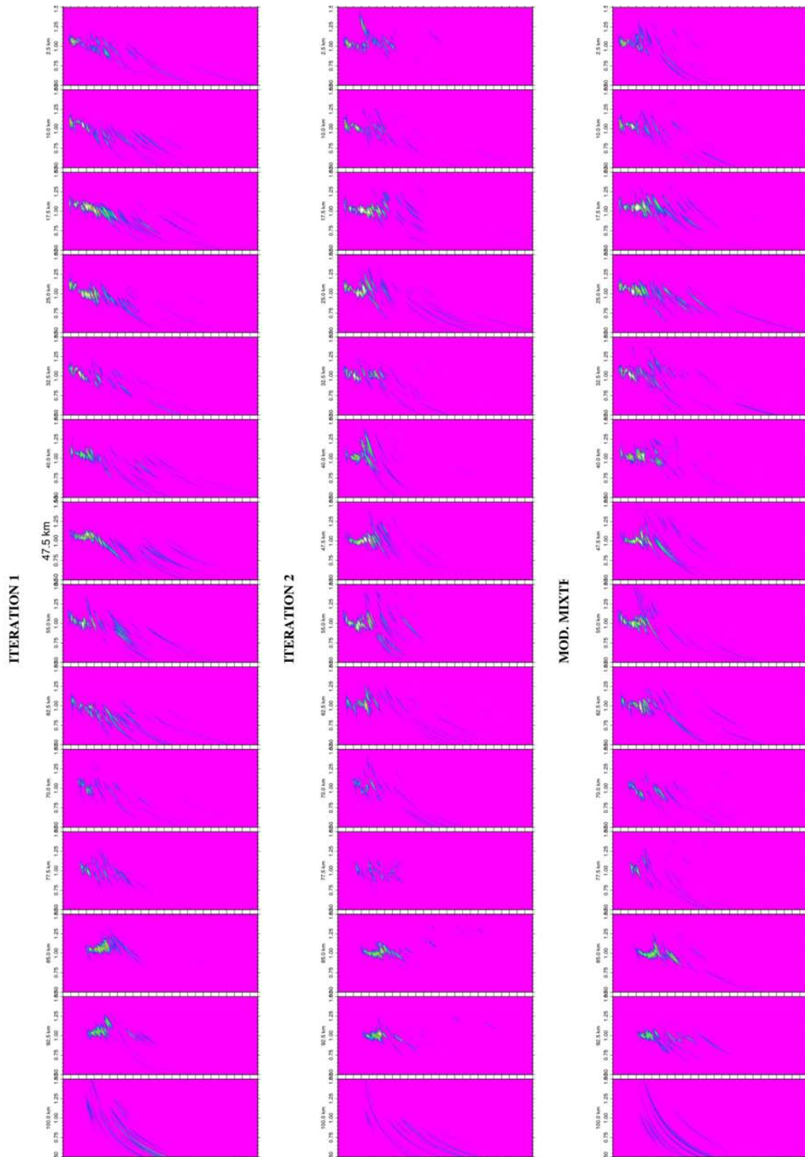
FIG. 6.10 – Panneaux de semblance profil 44 correspondant aux panneaux iso-X sur la figures 6.9, respectivement.
