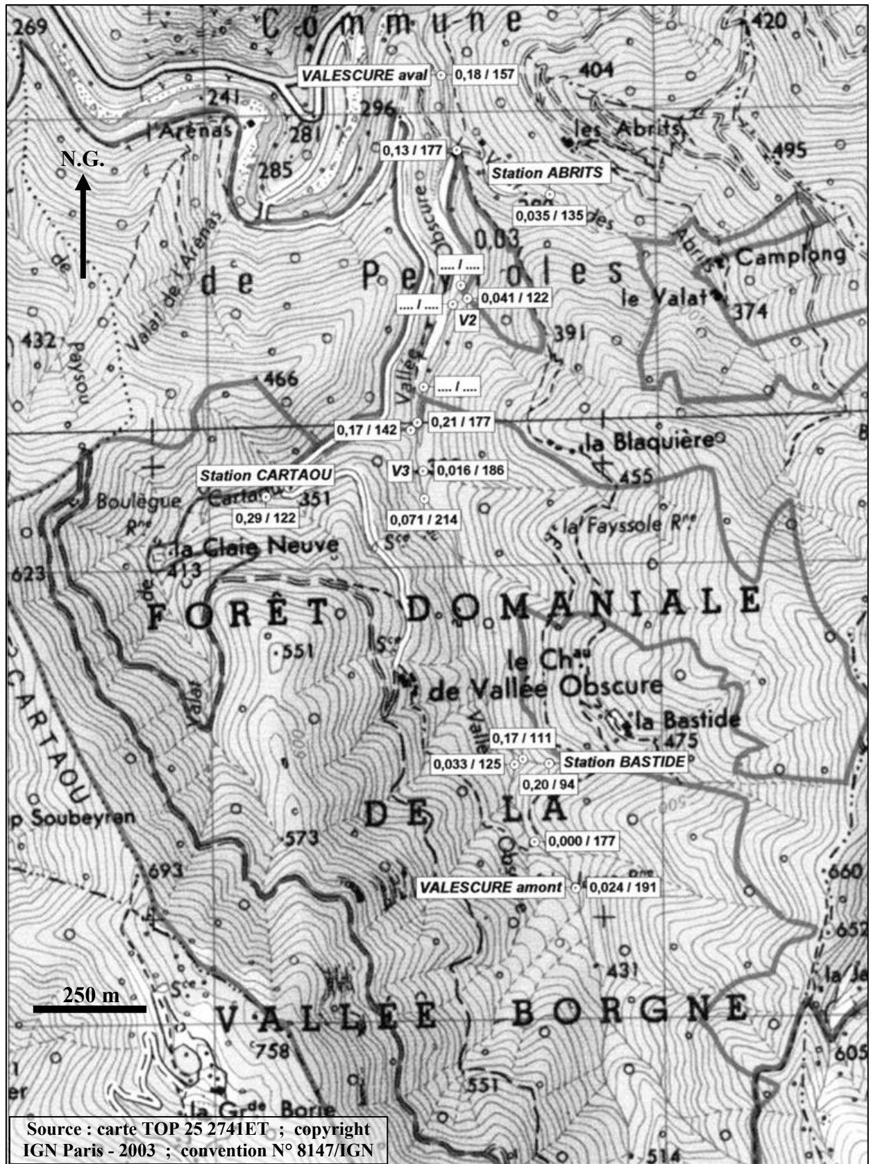
Fig. 7.4 - Campagne de jaugeages du 4 septembre 2005 (débit en l/s / conductivité en \mu\text{s}/\text{cm}/\text{cm}^2 ; .... : absence de mesure).
