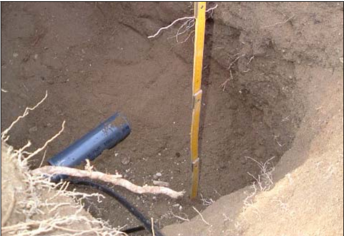
Photo 2.4 - Mise en place d'une sonde TDR dans une fosse.
