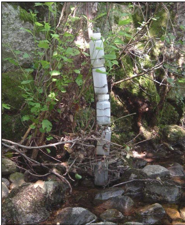
Photo. 10.1 - Collecteur pour le prélèvement d'échantillons d'eau en montée de crue sur le ruisseau de Valescure aval.
