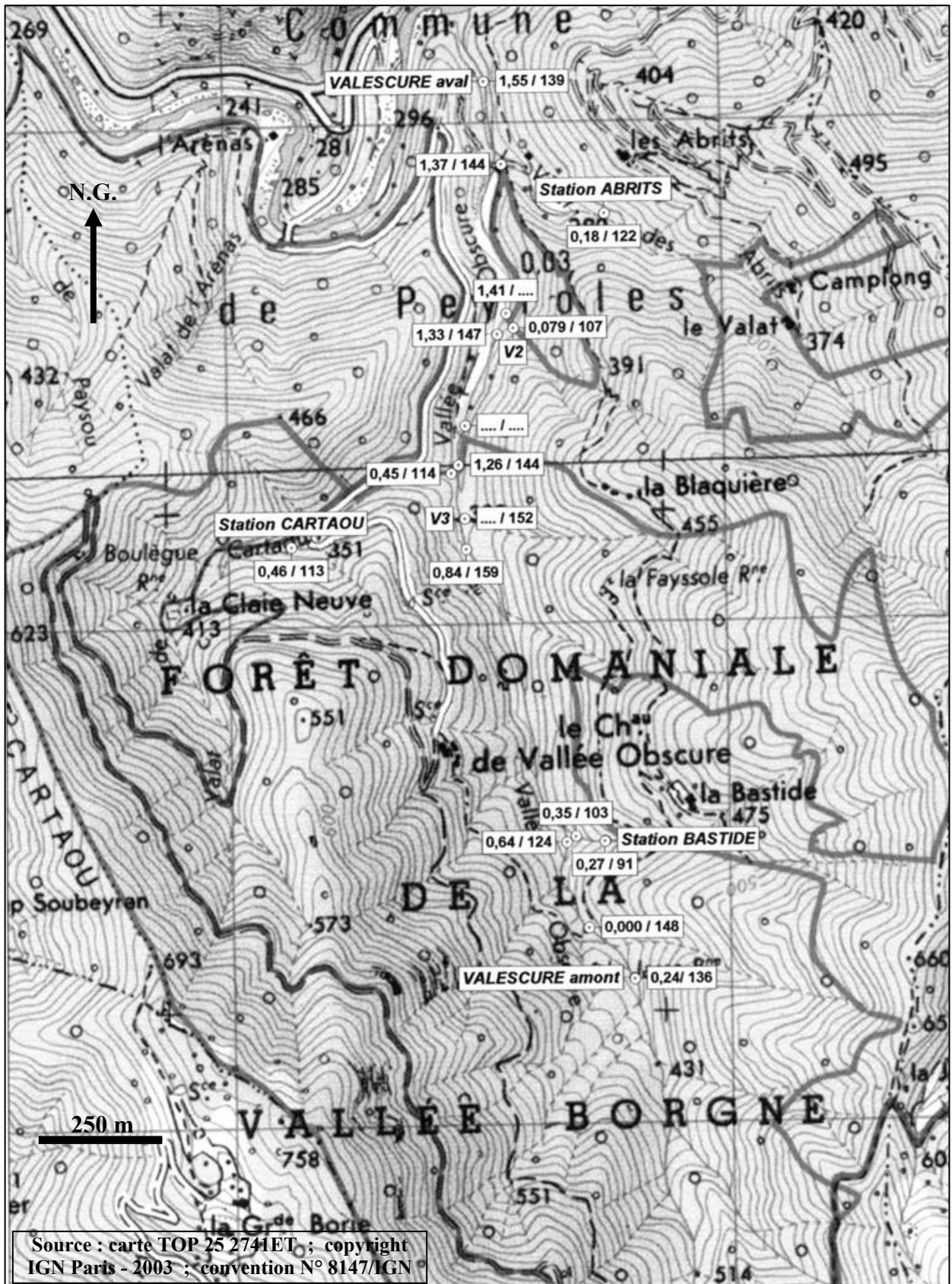
Fig. 7.2 - Campagne de jaugeages du 7 juillet 2005 (débit en l/s / conductivité en \mu\text{s}/\text{cm}/\text{cm}^2 ; .... : absence de mesure).
