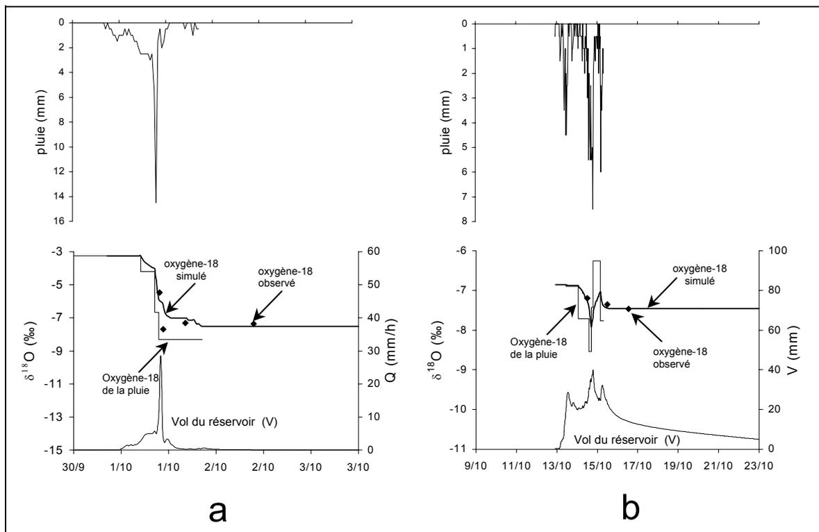
Figure 9 - Comparaison entre les  $\delta^{18}\text{O}$  observés et simulés dans l'eau du sol à partir d'un simple modèle de mélange utilisant les fractions successives de pluie.
