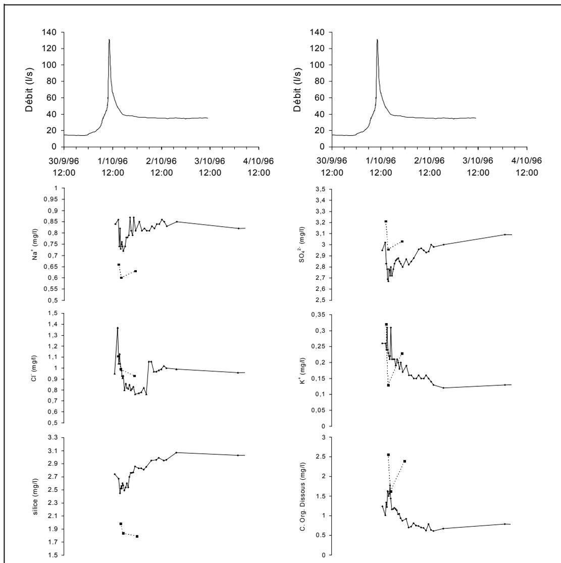
Figure 4 - Évolution des principaux éléments chimiques dans le ruisseau (ligne continue) et dans l'eau du sol (tirets) au cours de la crue du 1<sup>er</sup> octobre.
