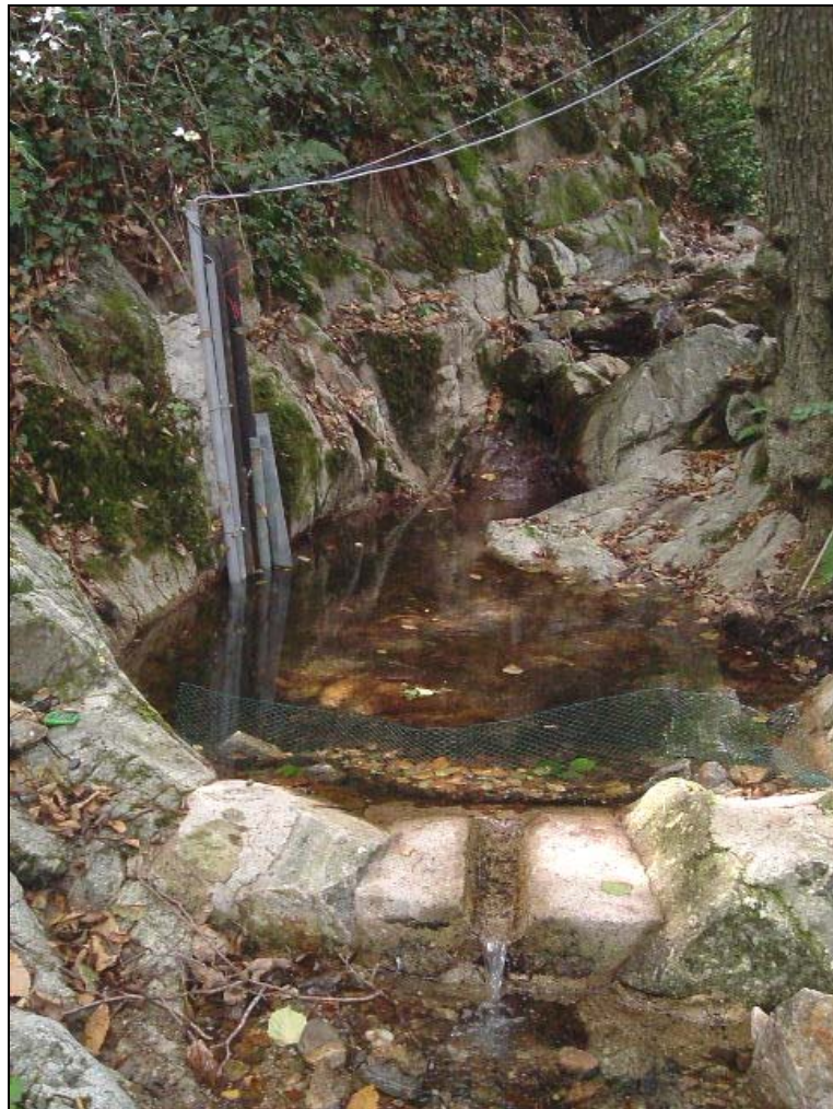
Photo 1 - Filet anti-feuilles à la station hydrométrique du ruisseau de Cartaou.
