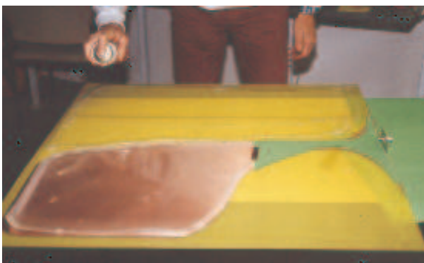
(a) Encollage de l'époxy à la colle néoprène
