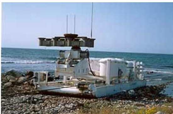
Figure I.8 Plates-formes de test pour antennes sous-marines
