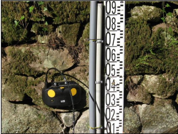
Photo 6 - Le courantographe du Valescure lors de sa mise en place le 20 octobre 2009.
