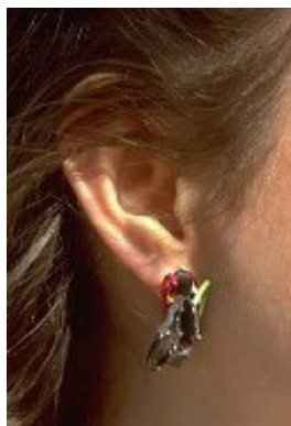
FIGURE 4.11 – Boucle d'oreille captant la pression sanguine
