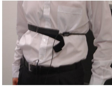
FIGURE 1.8 – capteur de respiration [Williams 2004]
