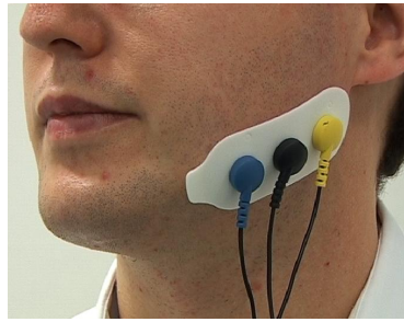
FIGURE 1.9 – capteur EMG appliqué sur le muscle de la mâchoire [Williams 2004]
