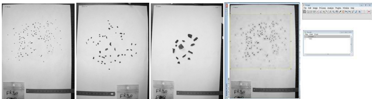
Planche 2 : Comptage des fragments par analyse d'image
