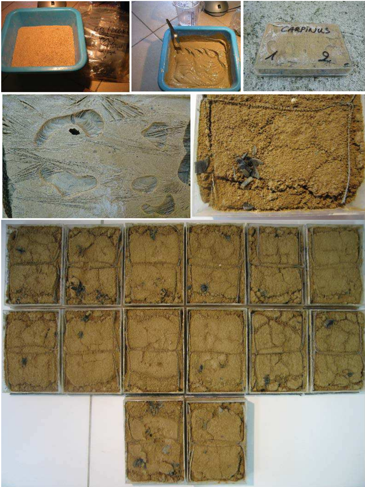
Planche 7 : De gauche à droite et de haut en bas : préparation du sédiment, aspect des boîtes et détail après une première phase de gel ; détail de la fragmentation des charbons après 400 cycles gel-dégel au moment du démontage ; en bas, toutes les boîtes après ouverture. On distingue nettement les fentes de cryodesiccations.
